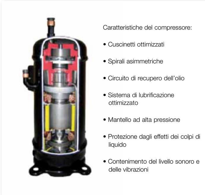
Caratteristiche del compressore:
